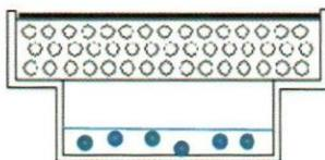
Figura N°1: Esquema de plato seco con material ensayado
